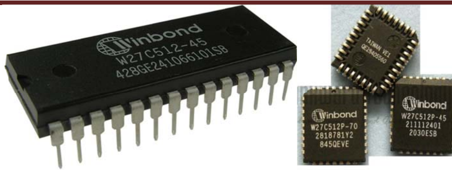
Рис. 2. ПЗП-мікросхема Winbond W27C512 ємністю 64 Кбайт в корпусі DIP28 (ліворуч) і PLCC32 (праворуч)
